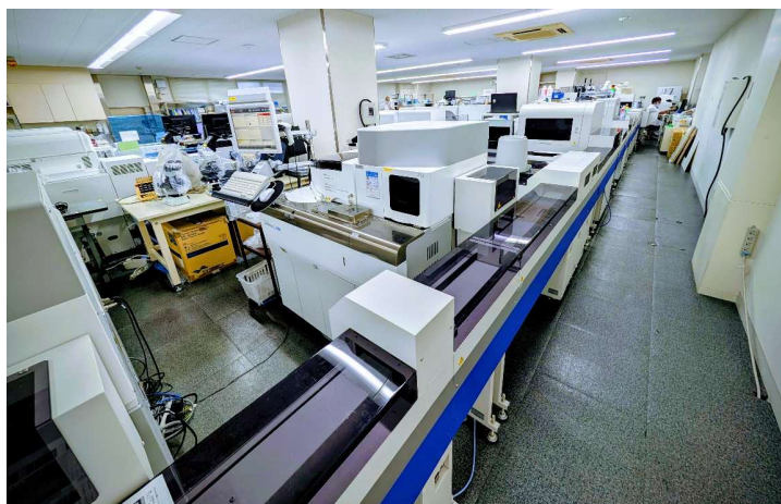
写真3. 新たに導入した検体搬送ラインと生化学・免疫測定装置
